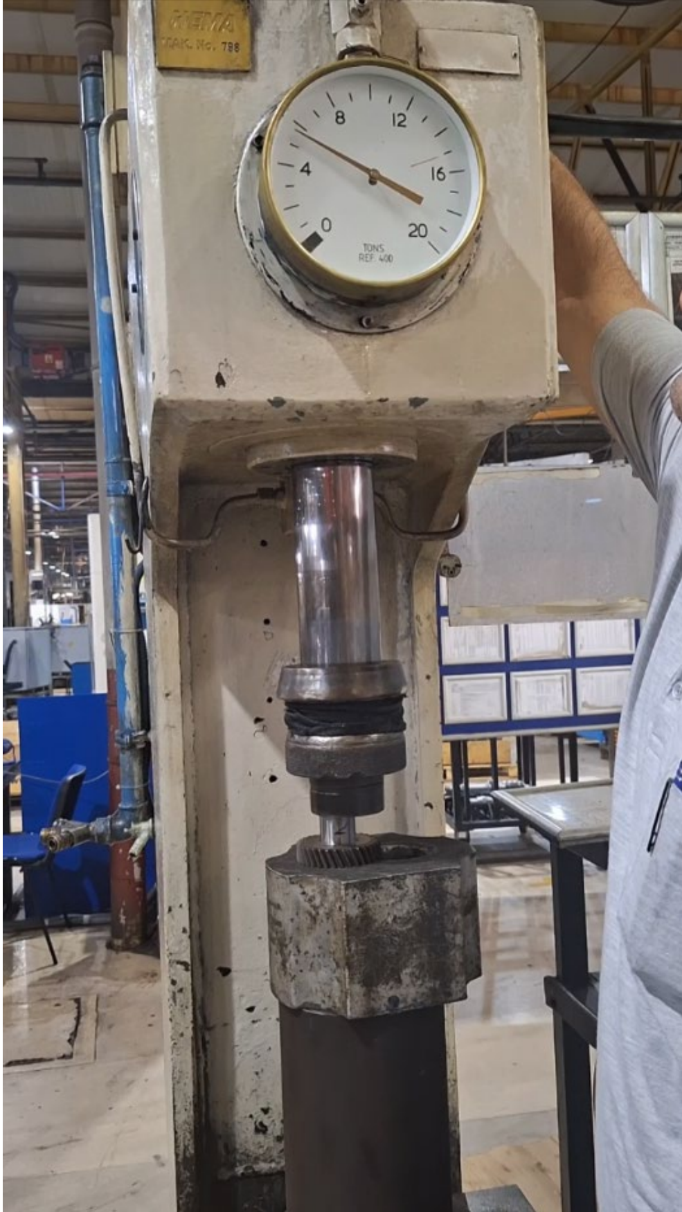
Şekil 5.9 Numune 2 — Hidrolik pres ekranında kaydedilen pik sökme kuvveti: 5.6 ton
