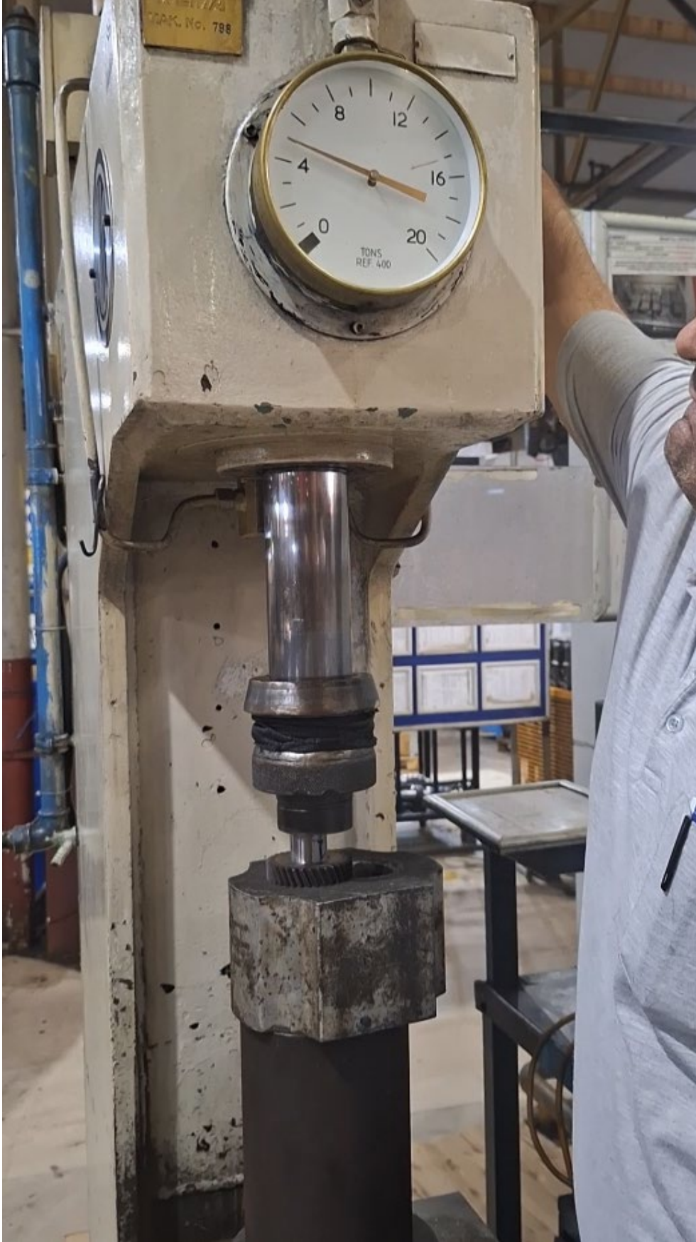
Şekil 5.8 Numune 1 — Hidrolik pres ekranında kaydedilen pik sökme kuvveti: 5.0 ton
