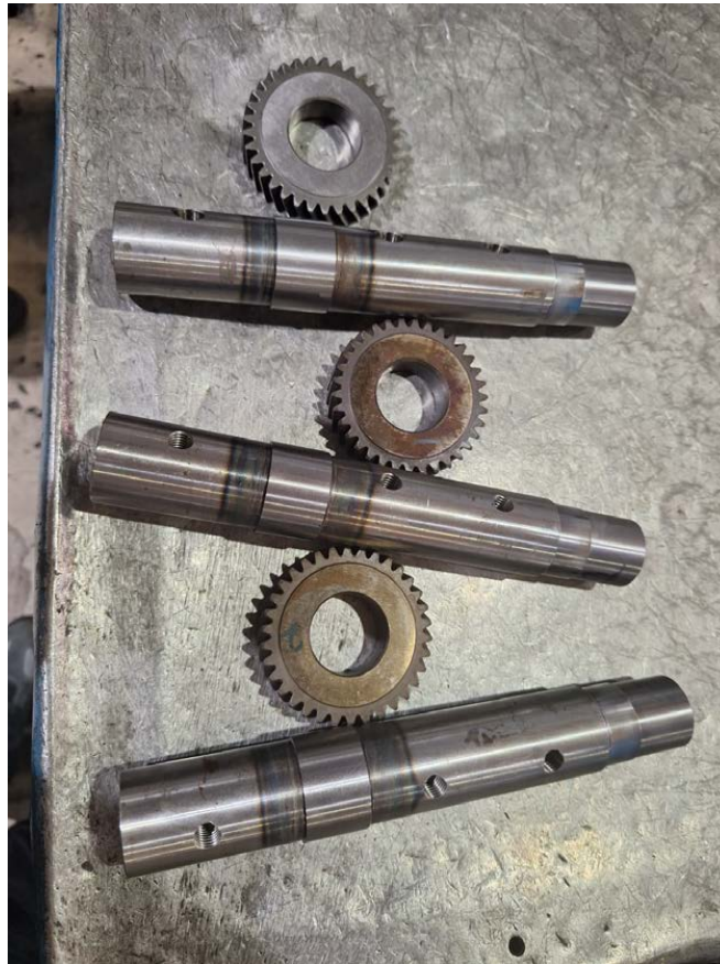
Şekil 5.1 Deney öncesi hazırlanan SAE 4140 mil ve SAE 8620 helis dişli (göbek) numuneleri
