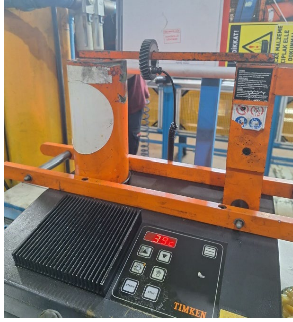
Şekil 1.11 Orta frekanslı indüksiyon bobini ile dişli ısıtması
