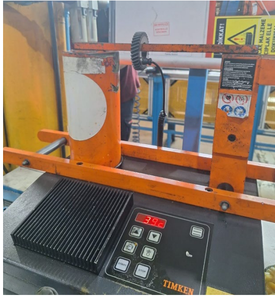
Şekil 5.7 İndüksiyon bobini ile N3 numunesinin ısıtılması
