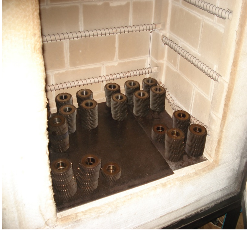
Şekil 1.10 Endüstriyel elektrikli fırın ile dişli ısıtması
