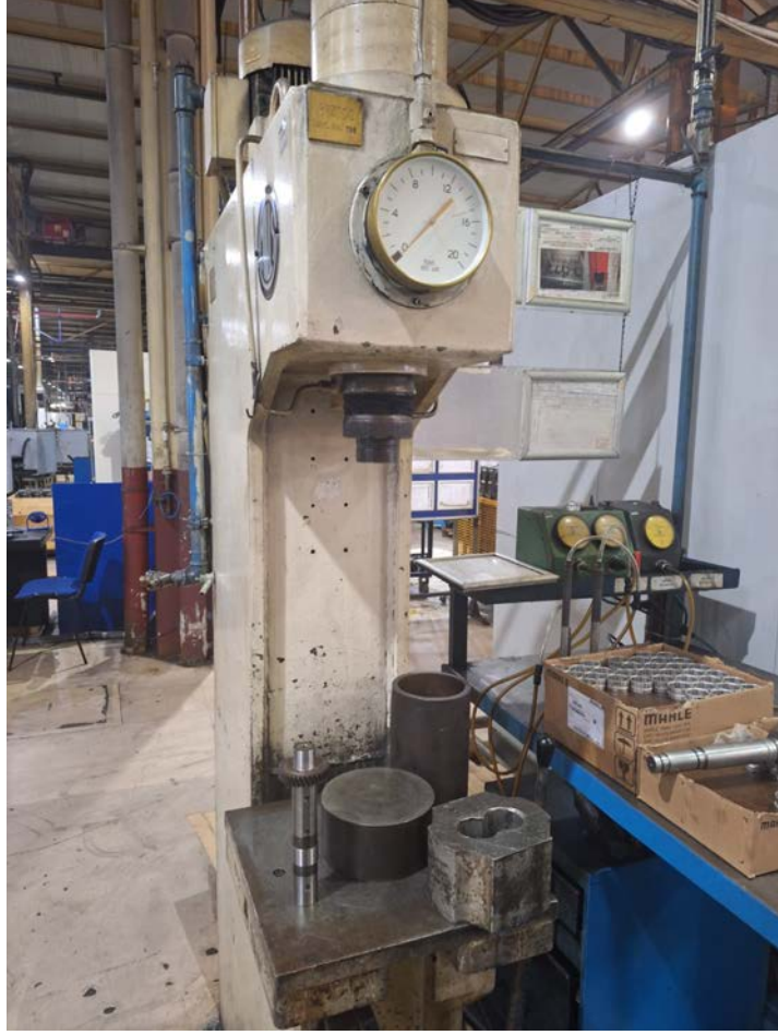
Şekil 1.13 Hidrolik pres ile gerçekleştirilen sökme deneyi düzeneği
