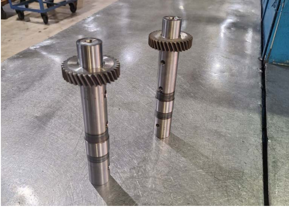
Şekil 5.2 Sıkı geçme yöntemiyle monte edilmiş numuneler
