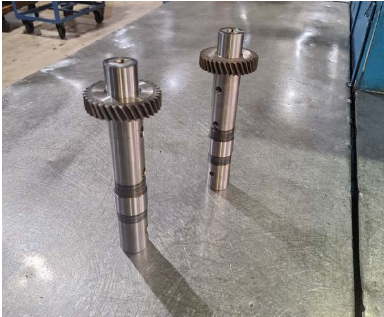
Şekil 1.7 Sıkı geçme yöntemiyle monte edilmiş göbek-mil numuneleri
